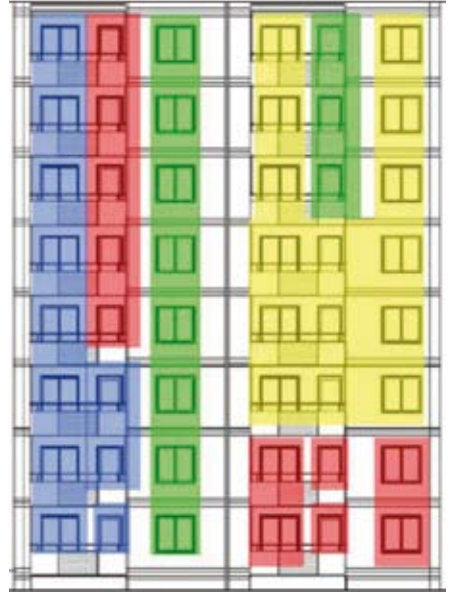
Ljudisolering R_{A,tr} ( =R_w+C_{tr} ), österfasaden: Grönt = 27; Gult = 32; Rött = 35; Blått = 38 dB.
