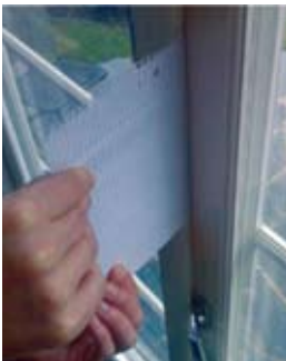
Pappersprov av tätning karm – dörr.
