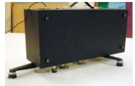
Stegljudsapparat fabrikat Bruel&Kjaer. Källa: SIS teknisk rapport 2007:15.
